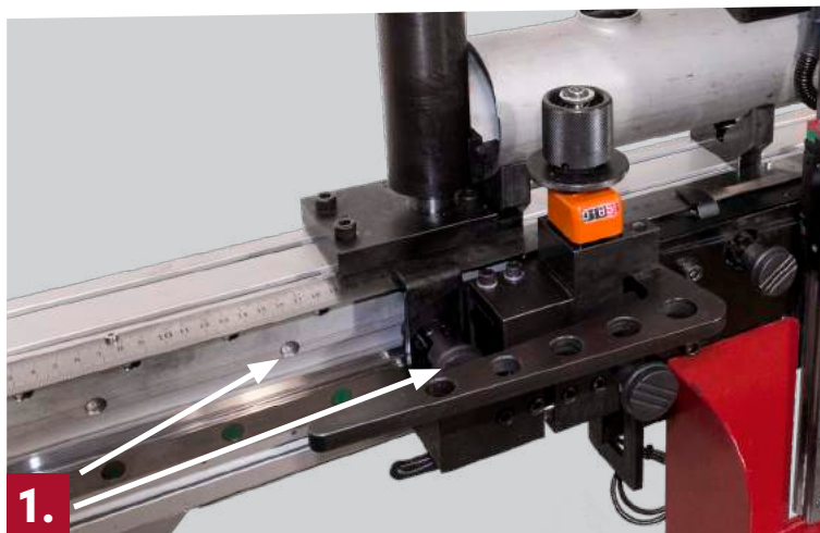
1. Posicionamiento fácil y exacto de pasador a orificio, con placa de índice en dos intervalos personalizados
